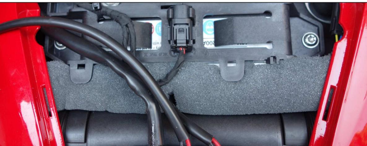
Non è necessario smontare i fianchetti, ma solo la copertura centrale del finto serbatoio.
