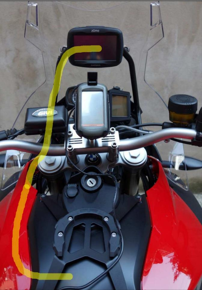
Ho quindi montato il supporto GPS seguendo le istruzioni del costruttore e senza utilizzare alcuno strato isolante (tipo nastro) tra il telaio e il supporto stesso, altrimenti con le dilatazioni termiche non assicura buona tenuta.
